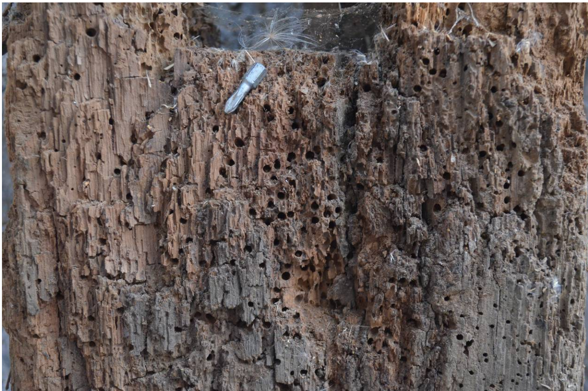
Abb. 79: Von Pilzen und Gescheckten Nagekäfern intensiv zerstörtes Eichen-Holz
