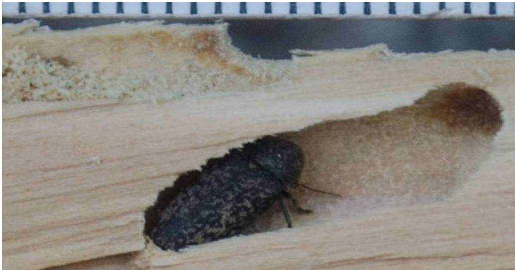
Abb. 67: Gescheckter Nagekäfer im Fraßgang (5 – 7 mm lang, im Bild mm-Skala)
