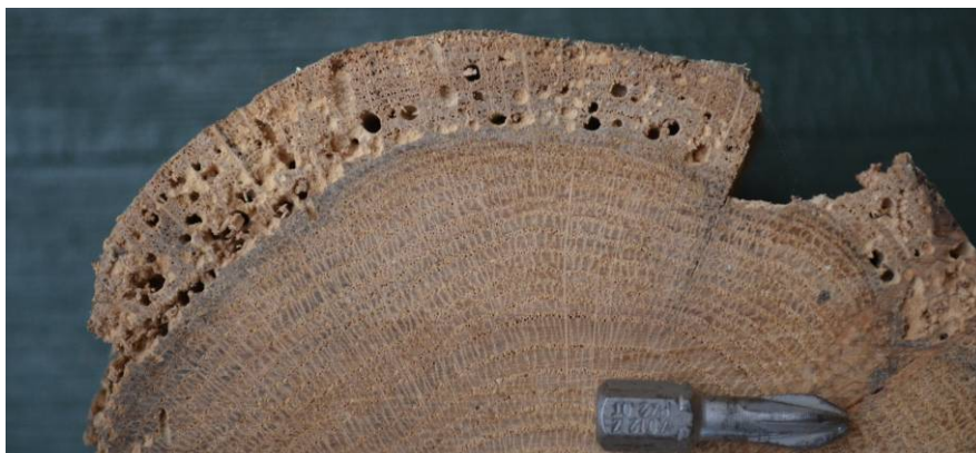
Abb. 71: Von Gewöhnl. Nagekäfern befallenes Eichen-Rundholz. Anobium punctatum kann ausschließl. das Splintholz der Eiche verwerten, der Kern bleibt selbst bei hohem Befallsdruck unangetastet.
