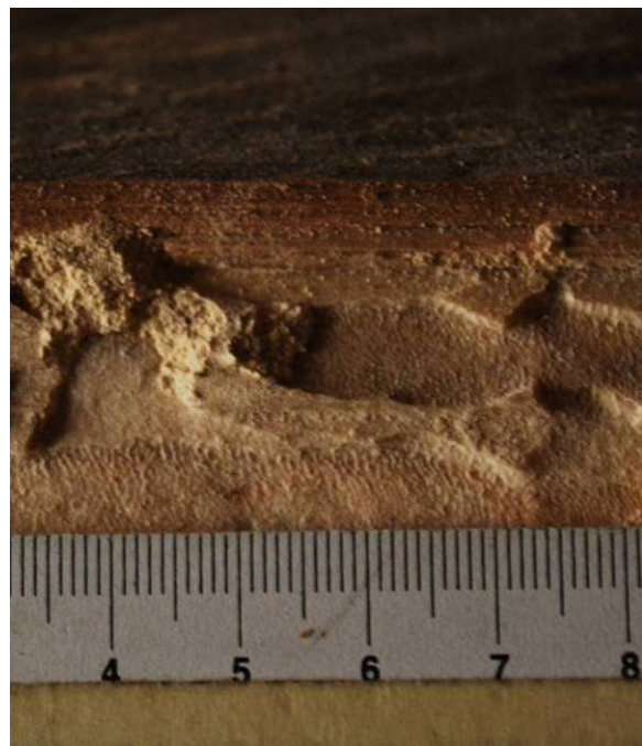
Abb. 73 und 74: Larve des Hausbock-Käfers (links) sowie Fraßgänge mit der arttypischen, wellenförmigen Struktur (rechts)
